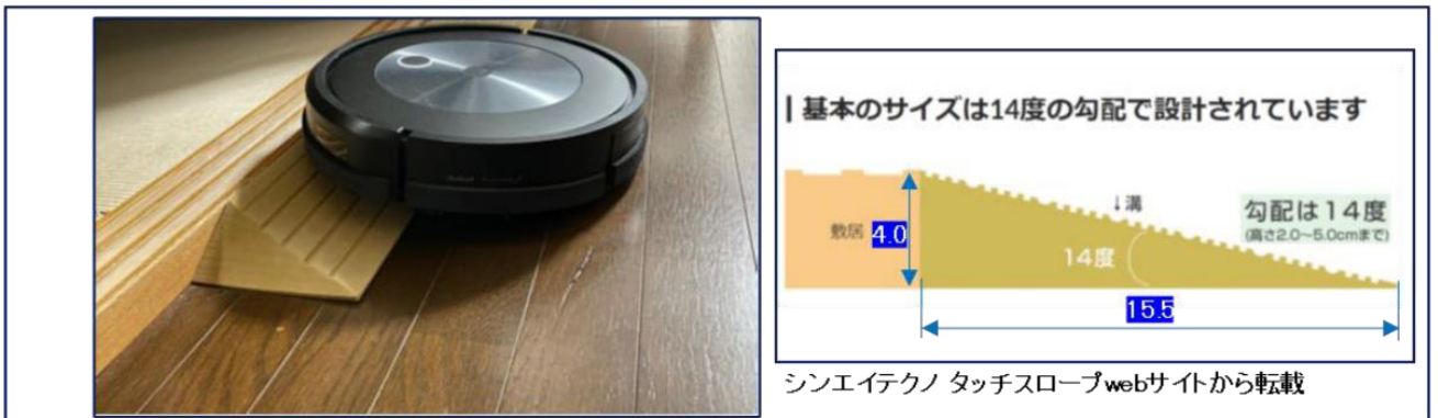
図5 ロボット掃除機は段差解消スロープがあれば段差4cmを越えられる
