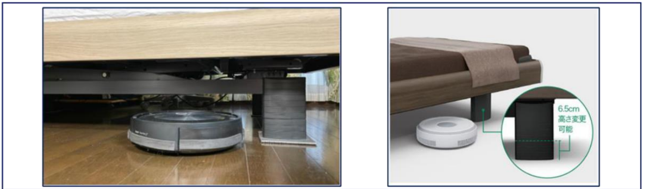
図1 ロボット掃除機に必要な電動ベッド下の高さ 左:在宅例 右:パラマウントベッドINTIME1000 パラマウントベッド webサイトから転載
