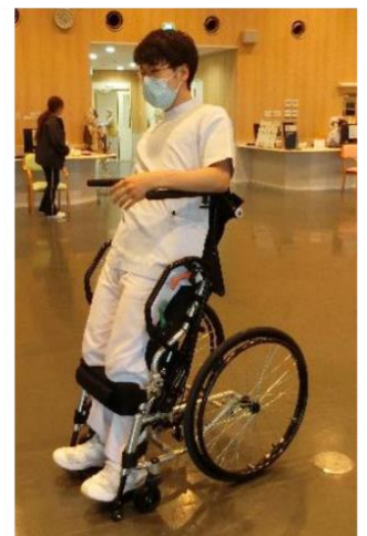
座位姿勢では一般車いすと同じようにこげる（左） 中間立位でも少しずつ移動できる（右）
