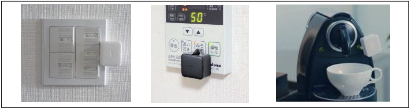
図3 スイッチボットの設置例
