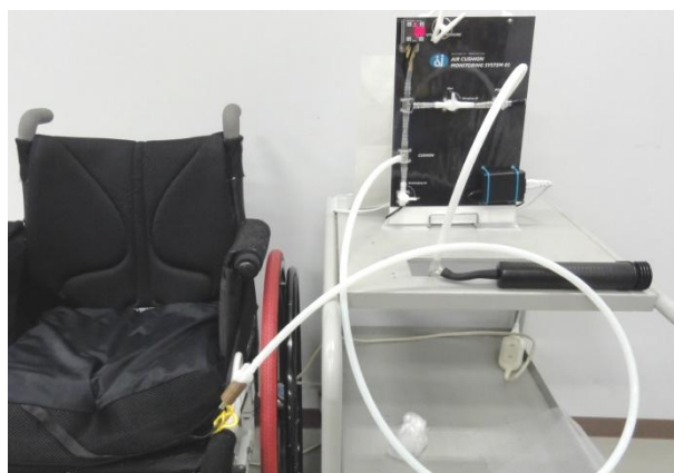
図5. 内圧測定・空気圧調整システム
