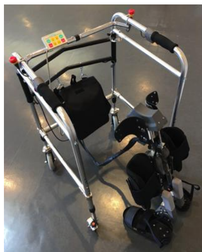
固定型歩行器に制御システム・バッテリーなどを配置。歩行器の把持部分にコントローラーがあり、患者自身がロボットを操作する。
